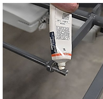
Appliquer de la graisse sur l'essieu
