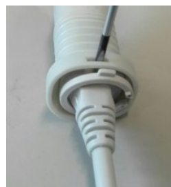
Démontage de la bague de verrouillage à l'aide d'un tournevis à lame plate
