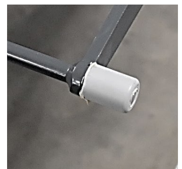
Remonter les patins de roue sur l'essieu
