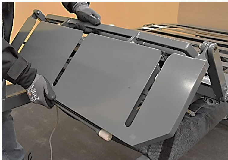
Les patins de roue de la partie jambe sont retirés du profil en U
