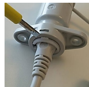
Démontage de la bague de verrouillage à l'aide d'un tournevis à lame plate
