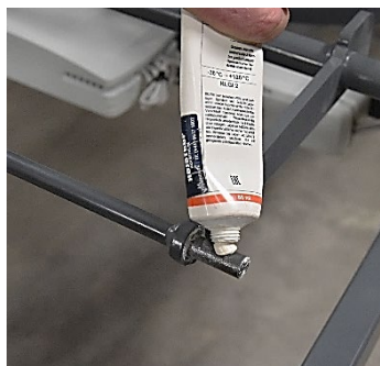
Appliquer de la graisse sur l'essieu
