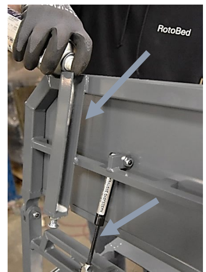
Vaporisez dans le profilé en U et sur la traverse fine
