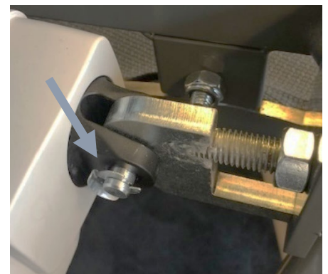
Emplacement du boulon de l'autre côté du moteur
