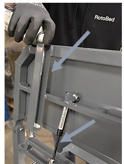
Vaporisez dans le profilé en U et sur la traverse fine
