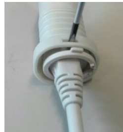
Démontage de la bague de verrouillage à l'aide d'un tournevis à lame plate
