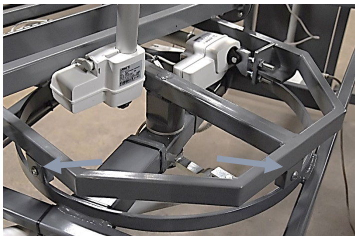
Emplacement des timoneries. Il y a au total cinq timoneries
