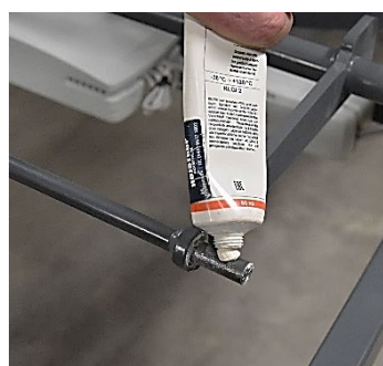
Appliquer de la graisse sur l'essieu
