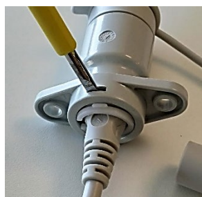
Démontage de la bague de verrouillage à l'aide d'un tournevis à lame plate
